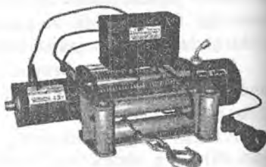
5.23-rasm. Agregatlarni avtomobildan ko'tarish-tashish jihozlari
