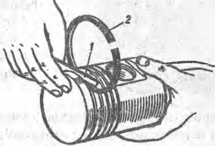
3.21-rasm. Porshen halqasi va ariqchasi orasidagi tirqishni tekshirish shakli
