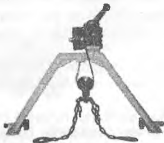
5.23-rasm. Agregatlarni avtomobildan ko'tarish-tashish jihozlari
