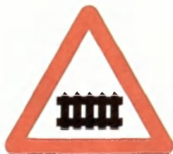
Shlagbaumli temir yo'l kesishmasi
