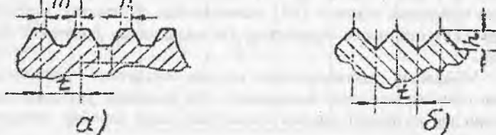
2.6-расм. Жағлари мураккаб ҳаракат қиладиган майдалагич: а) трапециясимон; б) учбурчаксимон.
