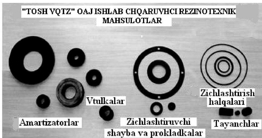
14.11-rasm. Toshkentdagi yo'lovchi vagon qurish zavodida vagonlarni ta'mirlash va qurishda qo'llaniladigan rezinotexnik maxsulotlar
