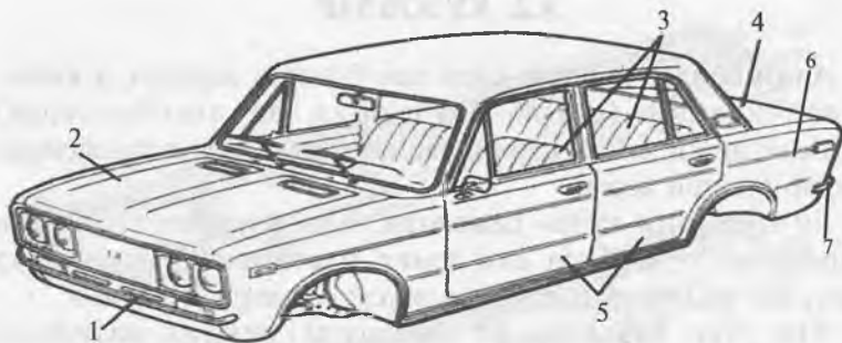
5.4-расм. Юкламани тўла қабул қилувчи енгил автомобил кузови: 1-олдинги бампер; 2-двигател капоти; 3-ҳайдовчи ва йўловчи ўриндиқлари; 4-юк хонасининг қопқоғи; 5-эшиклар; 6-қанотлар; 7-кетинги бампер.
