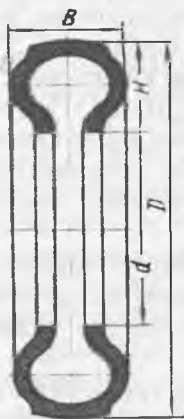
4.6 - расм . Ш и н а н и н г ў л ч а м л а р и : д - ў г и н и н г д и а м е т р и ; В - ш и н а н и н г э н и ; Н - п р о ф и л и н и н г б а л а н д л и г и ; D - ш и н а н и н г т а ш қ и д и а м е т р и .
