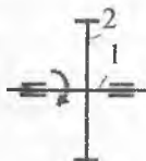
Aylanuvchi o'qda mahkam o'tirgan silindrsimon shesterniya. 1-o'q; 2-shesterniya.
