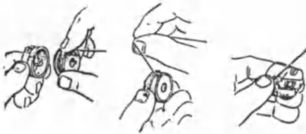
41-rasm. O'qi gorizontal joylashgan mokili mashinalarda ipli naychani naychatutqichga o'rnatish tartibi.
