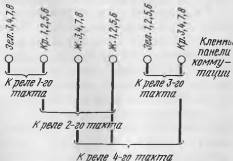
Рис. 4.5. Пример коммутации ламп светофоров для двухфазной схемы
