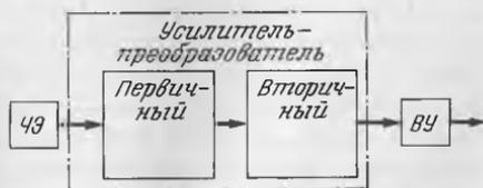
Рис. 5.1. Общая структурная схема ДД
