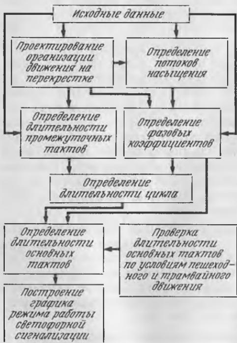
Рис. 3.9. Последовательность расчета длительности цикла и его элементов
