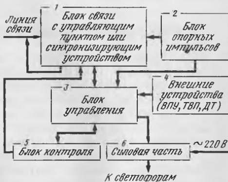
Рис. 4.1. Обобщенная структурная схема контроллера:
