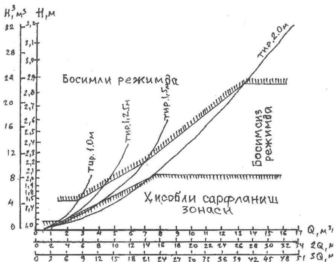
5.15-rasm. Temirbeton yumaloq, diametri 1...2 m ga teng quvurlarning suv o'tkazish imkoniyati
