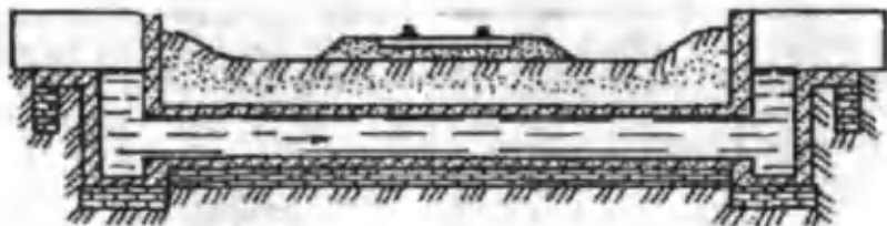
5.16-rasm. Dyukering bo'ylama kesimi.
