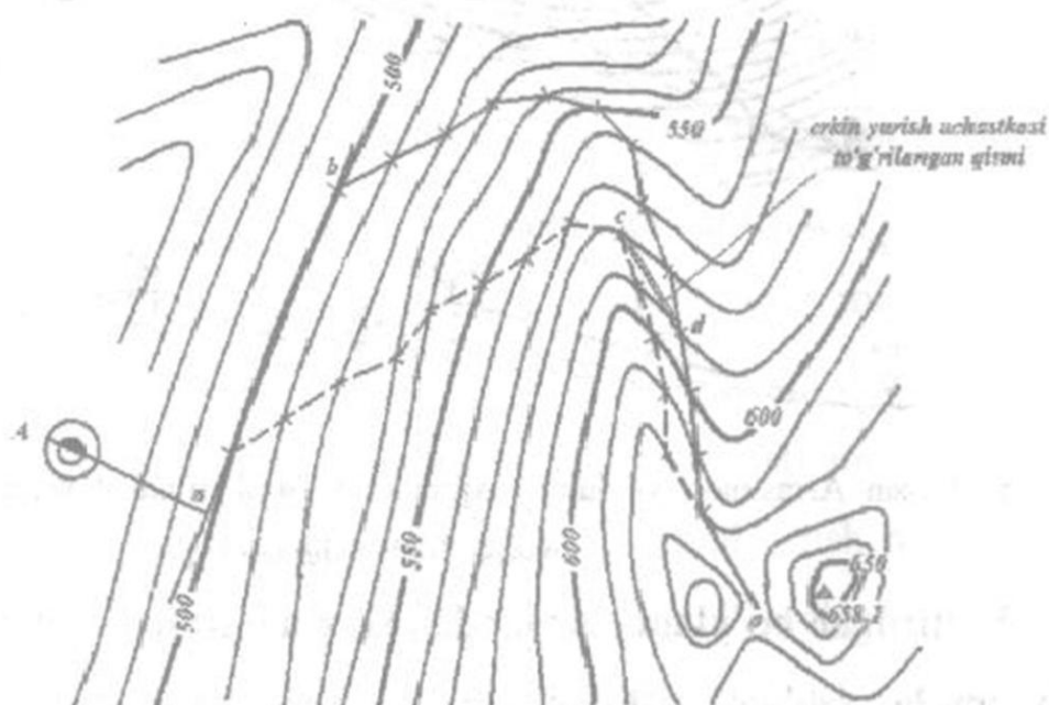
5.19- rasm. Zo'riqib va erkin yurish uchastkalarini galma- gal qo'llash evaziga trassa uzunligini qisqartirish
