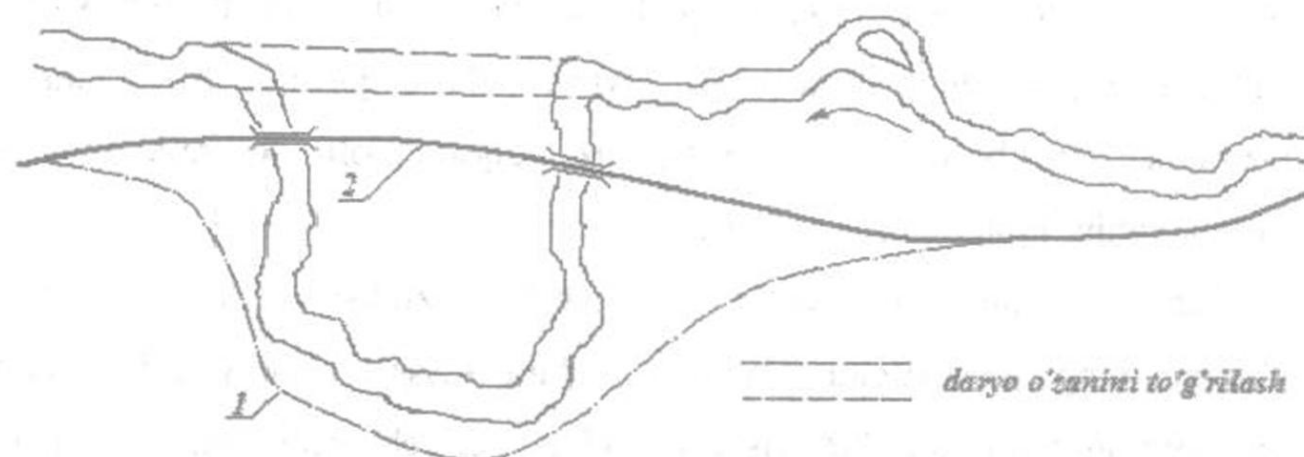
5.12-rasm. Daryoni aylangan katta uchastkalarida (izluchina) temir yo'l trassasi variantlari
