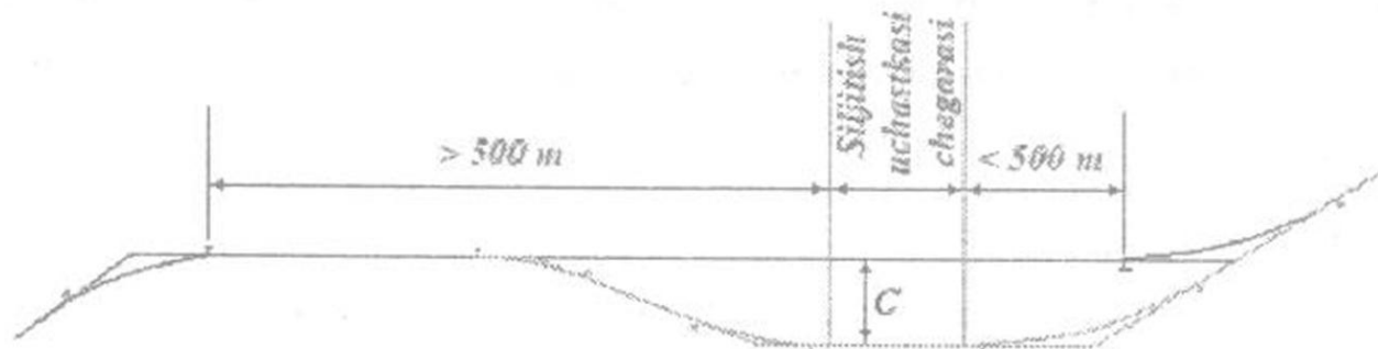
9.27-rasm. Temir yo'l o'qini siljitish sxemasini tanlash.
