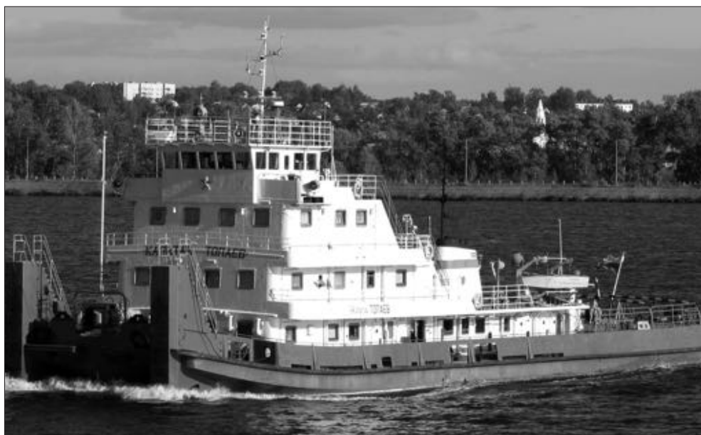
Рисунок 3.3. Толкач-буксир пр. 428 мощностью 2000 л.с.
