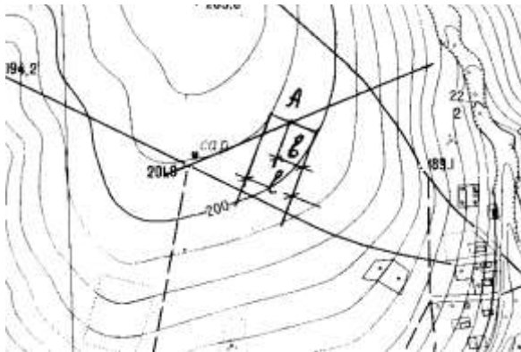
Рис 8.1. Схема определения высотной отметки точки А методом интерполяции.
