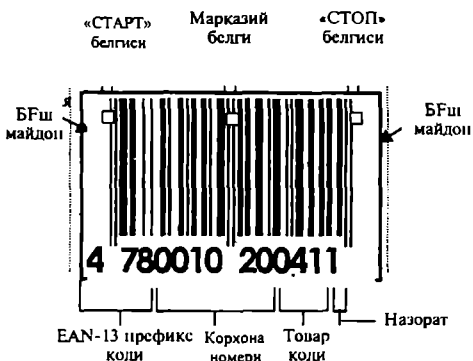
18.1-расм. EAN-13 кодининг структураси
