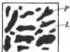
2.3-rasm. Evtetik oq choʻyan strukturasi
