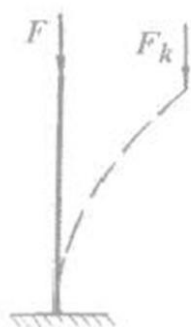
10.2-rasm. Sterjenni ustuvor va noustuvor (punktir) holati.
