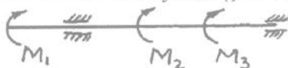
Shkivlardagi aylantiruvchi momentlar bilan yuklangan val
