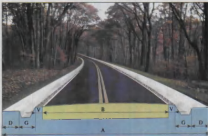
7.1-rasm. A - Yo'lning butun eni; B - Qatnov qismi; V - Yo'l yoqasi; G - Xandaqlar; D - Trotuar.
