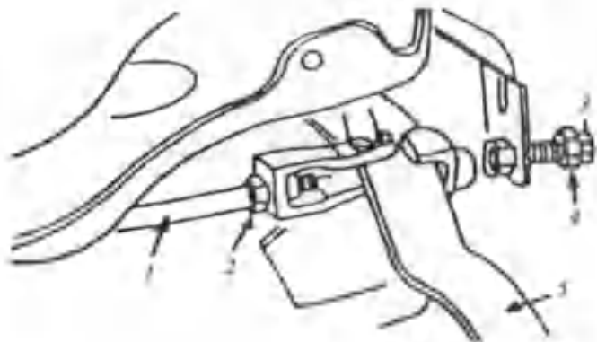
22-rasm. «Nexia» avtomobilining gidravlik yuritma ilashish muftasini rostlash nuqtalari.
