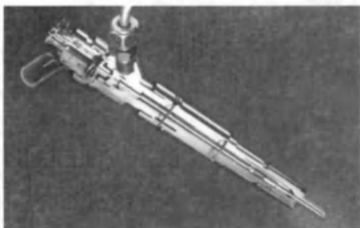
1.81-rasm. «BMW» dizelli dvigateli «Common Rail» tizimi forsunkasi.
