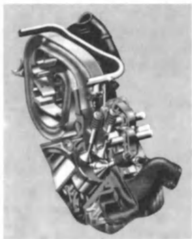
1.31-rasm. «Mercedes» dvigateli kirituvchi truboprovodi uzunligini doimiy o'zgartirish mexanizmining chizmasi.
