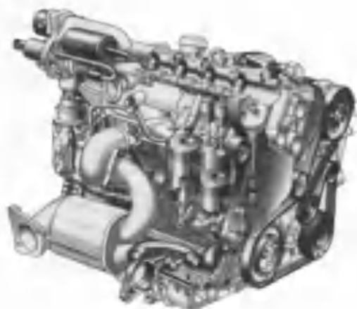
1.82-rasm. «Common Rail» tizimiga ega bo'lgan 1,9 litr hajmli «Renault» turbodizeli 2000-yilda ishlab chiqarilgan. Yonilg'i «reykasi» taqsimlash valiga parallel tarzda o'rnatilgan.
