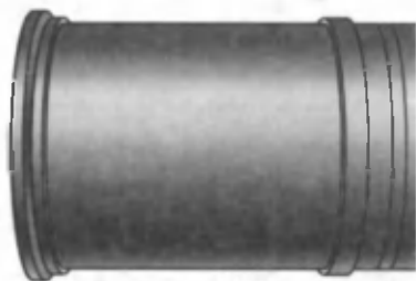
2.5-rasm. Kavitatsiyadan yeyilgan dizel gilzasi.
