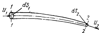
1.33- расм. Элементар оқимча учун узилмаслик тенгламасини чиқаришга оид чизма.
