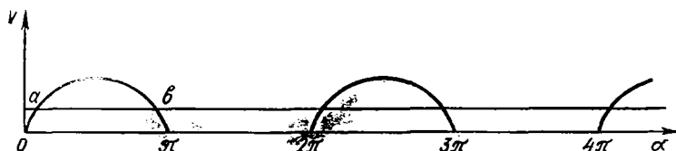
2.32- расм. Поршенли насосда сўришнинг нотекислигини кўрсатувчи схема.
