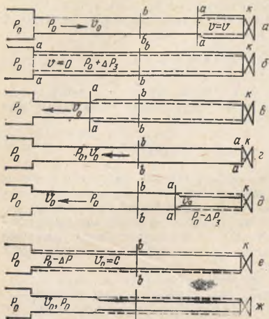
1.100- расм. Гидравлик зарба ҳодисасини тушунтиришга доир чизма.
