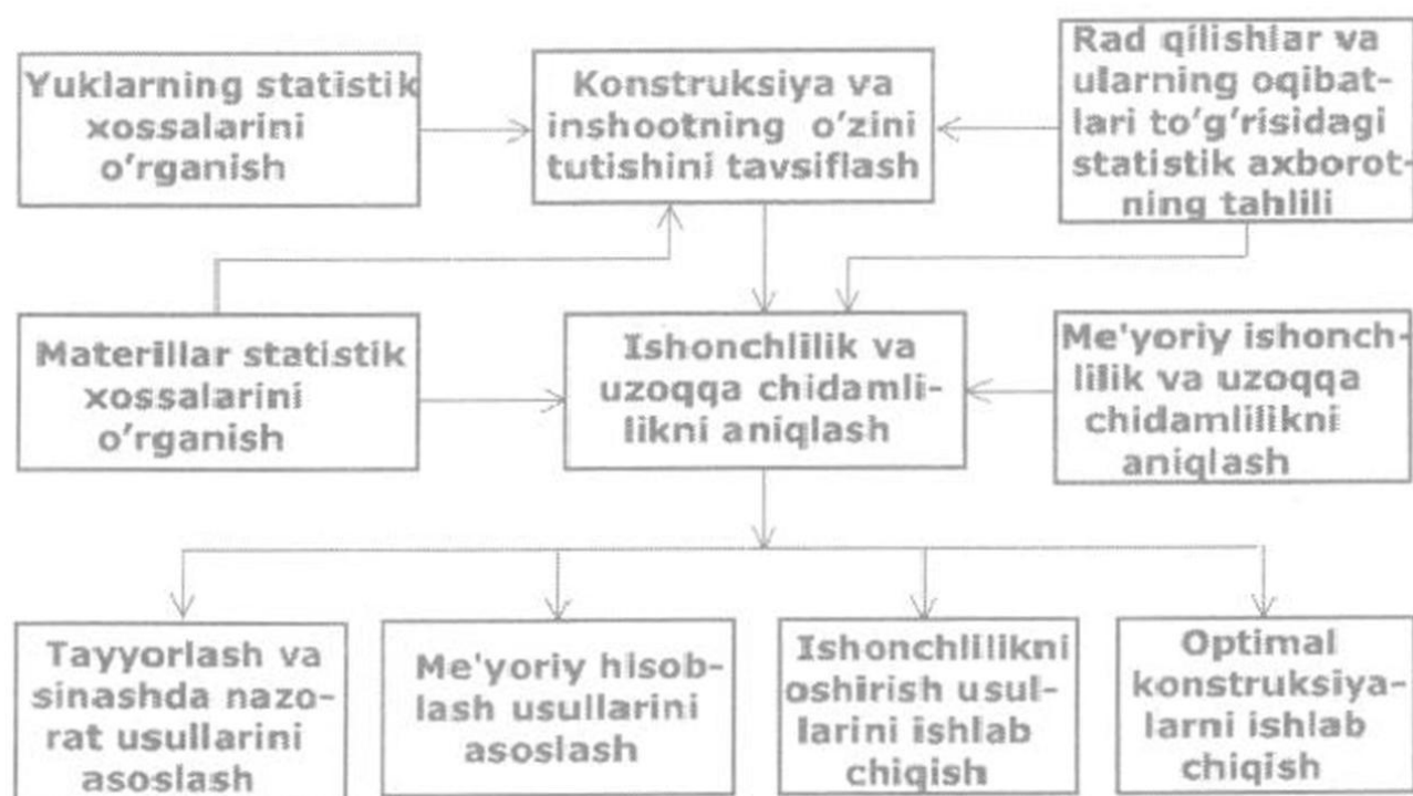
7.1-rasm. Transport inshootlari konstruksiyalarining ishonchliligi hisob-kitobining tuzilmaviy sxemasi
