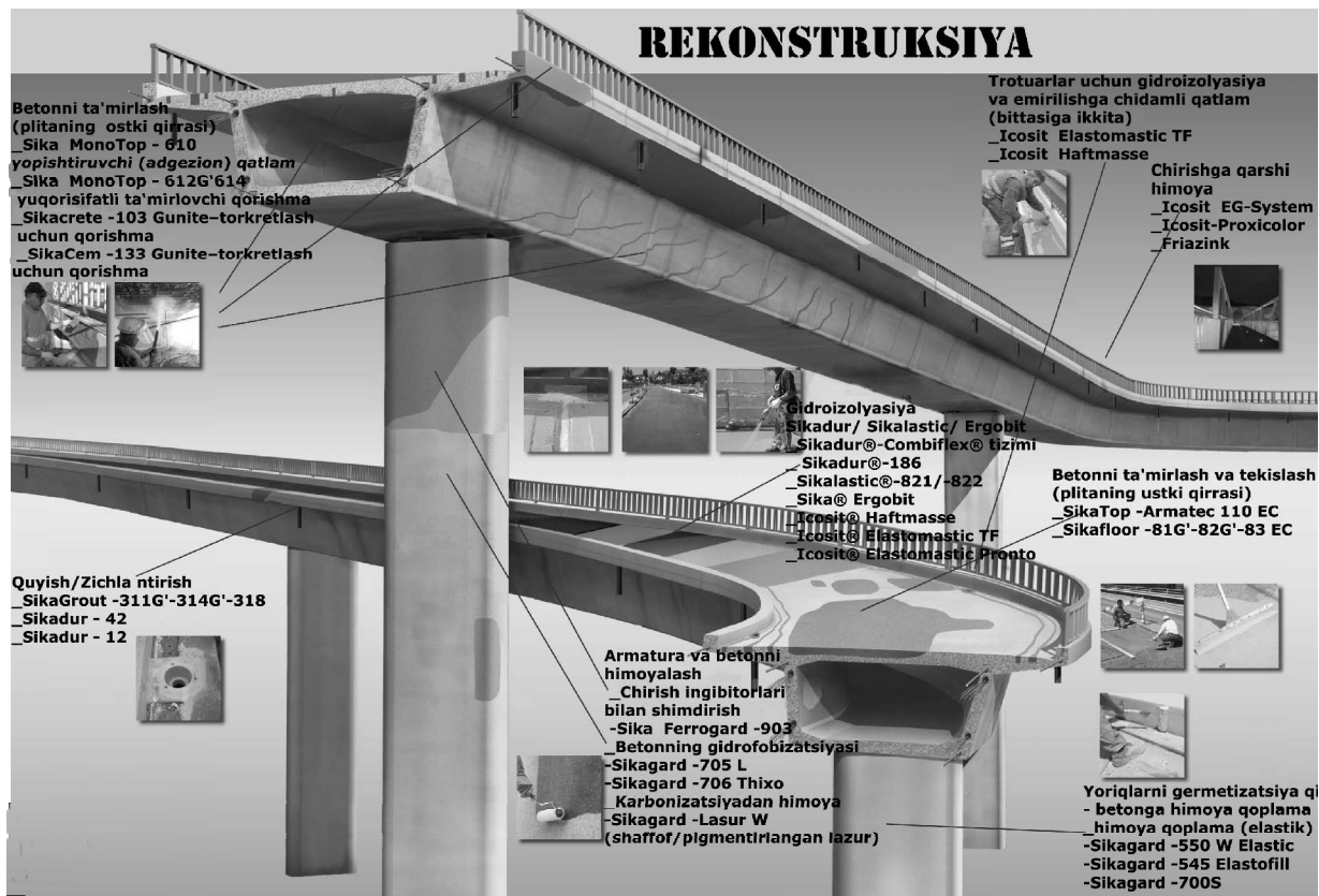
18-rasm. Ko'prik yuk ko'taruvchi konstruksiyalaridagi shikastlanishlar va ularning rekonstruksiyasi
