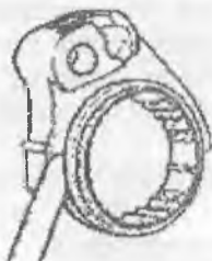
4.19-расм. Синхронизатор муфтаси билан босқичлаш ричаги орасидаги тирқишни текшириши.
