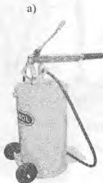
4.42-расм. Қўзғалувчан қуюқ мой мой тарқатувчи (а) ҳамда ишлатилган мойларни тўқши учун мосламалар (б).
