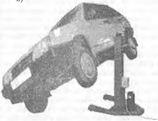
5.36-расм. Ағдаргич. а - умумий кўриниши; б - ағдариш жараёнида.
