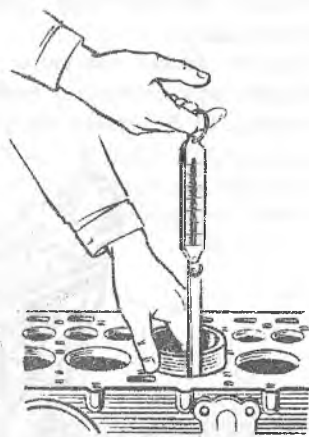
3.19-расм. Поршен ва цилиндр орасидаги тирқишни текшириш шакли.
