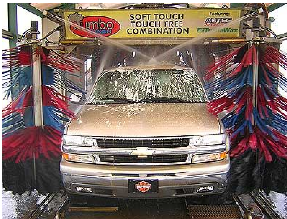
5.3-расм. Автомобилларни чўткалар билан ювиш пости.
