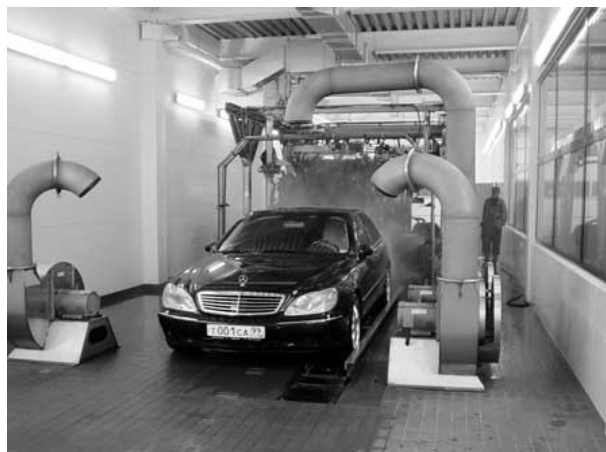
5.5-расм. Автомобилларни иссиқ ҳаво оқими ёрдамида қуритиш жиҳози.
