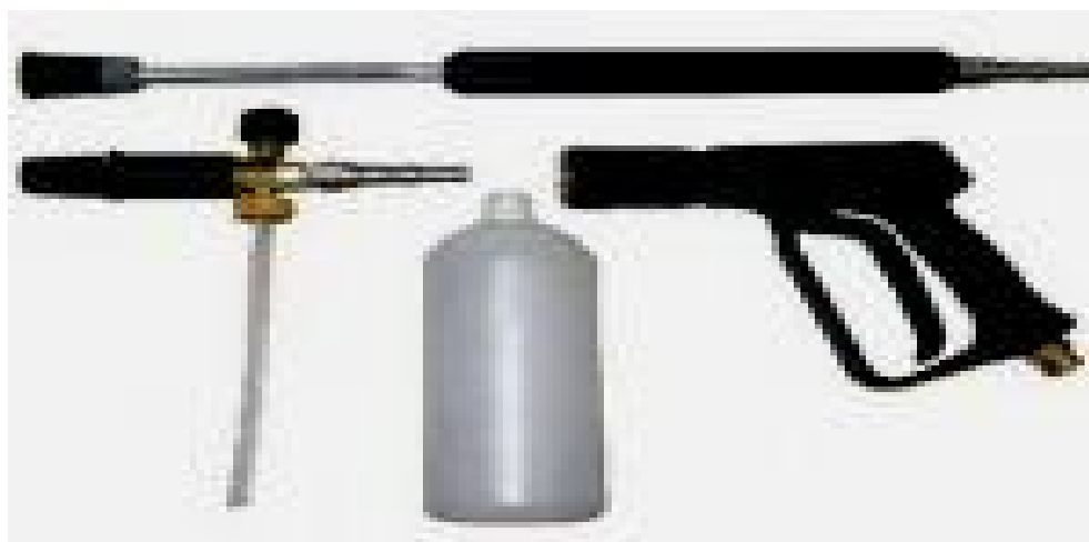
7.5-расм. Қўл билан ювишда ишлатиладиган сув сепгич (максимал босими 160 Bar, сув сарфи 20 л/мин; сувнинг максимал харорат 60 С°).
