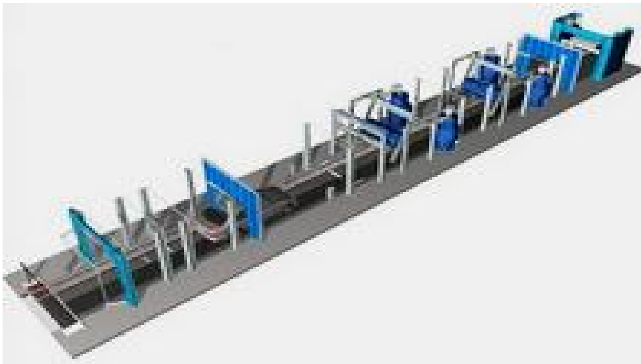
7.4-расм. Автомобилларни ювиш конвейери шакли (конвейернинг ҳаракатланиш тезлиги 3...4 м/мин).
