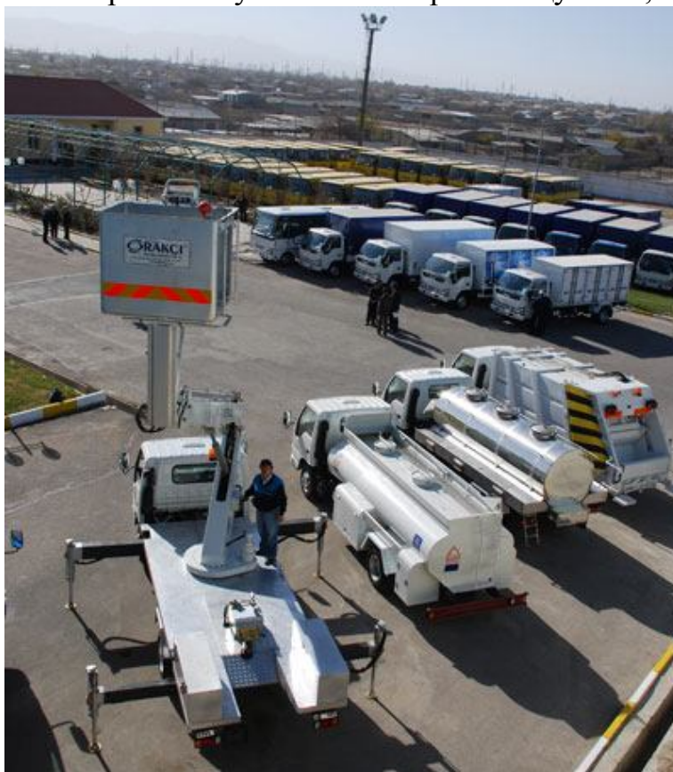
11.4-расм. «СамАвто» МЧЖ томонидан «ISUZU» (Япония) шасси асосида ишлаб чиқаралаётилган ихтисослашган автомобиллари
