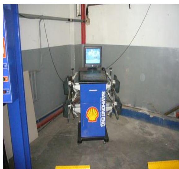
5.8-расм. Бошқарилувчи ғилдирақларни ўрнатиш бурчакларини созлаш пости
