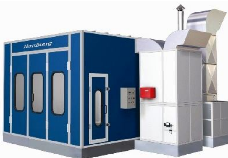
7.12- расм. Бўёлаш-қуришиш камераси, мод. НОРДБЕРГ ЕСОНОМИС
