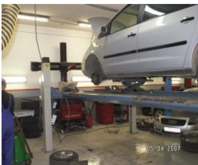
5.8-расм. Бошқарилувчи ғилдирақларни ўрнатиш бурчакларини созлаш пости
