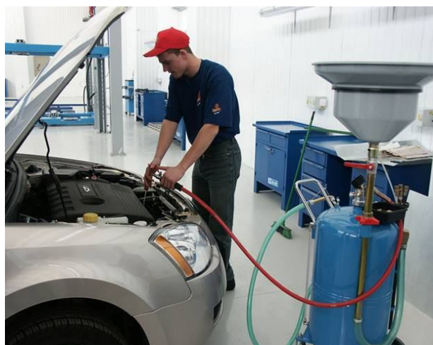
5.11-расм. Тизимларни техник суюқликлар билан таъминлаш пости
