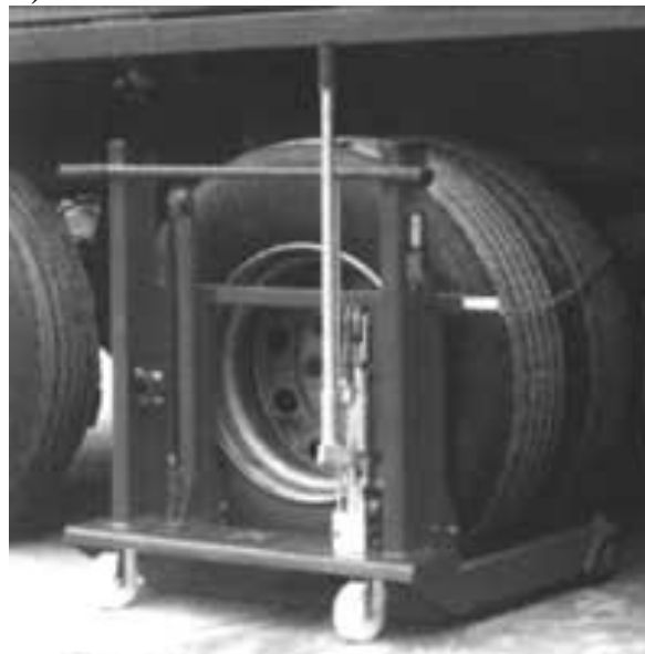
5.35.-rasm. Avtomobillar g'ildiraklarini echib olish, o'rnatish va tashish uchun aravacha. a- umumiy ko'rinishi; b- ish jarayonida.
