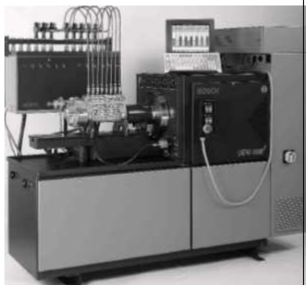
3.11-rasm. Yuqori bosimli yonilg'i nasosi (YuBYoN)ni sinash va rostlash jihozi, mod. DD10-01
