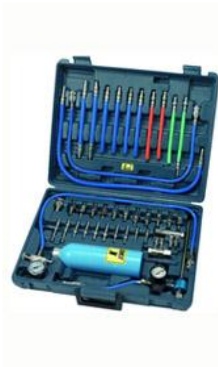
3.5-rasm. Injektorlar tizimini tozalash majmuasi.
