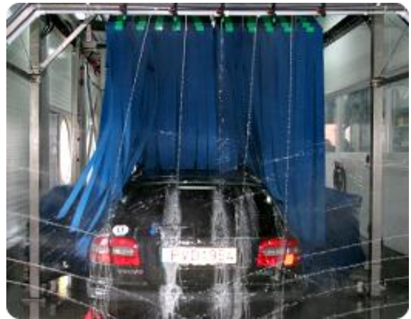
2.4-rasi. Engil avtomobillarni zarrachali yuvish jihozlari
