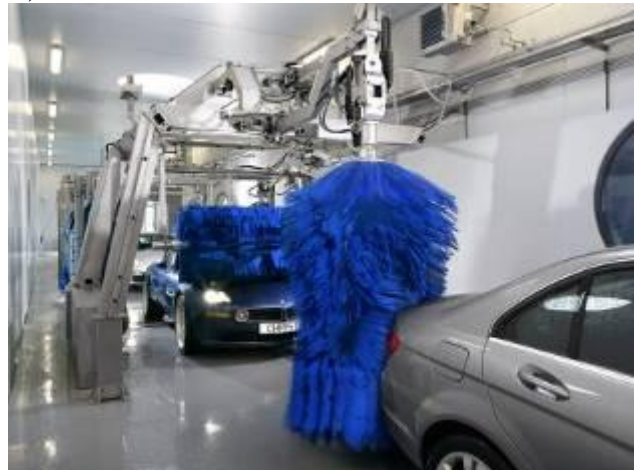
2.8-rasm. Engil avtomobillarni yuvish va quritish oqim qatori a-avtomobillarni cho'tkali yuvish jihozi; b-avtomobillarni quritish jihozi
