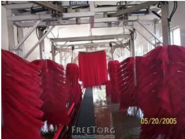
2.8-rasm. Engil avtomobillarni yuvish va quritish oqim qatori a-avtomobillarni cho'tkali yuvish jihozi; b-avtomobillarni quritish jihozi
