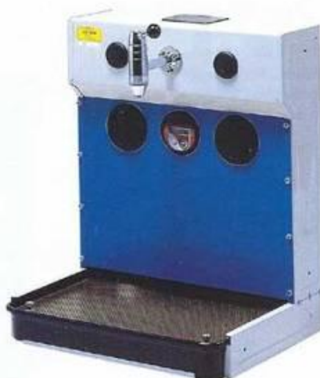
4.48-rasm. Raasm 37691 (Alfa 23200) rusumli antifriz va moylar bilan ta'minlash uskunasi.
