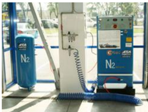
4.48-rasm. Shinani azot bilan to'ldirish jihozi
