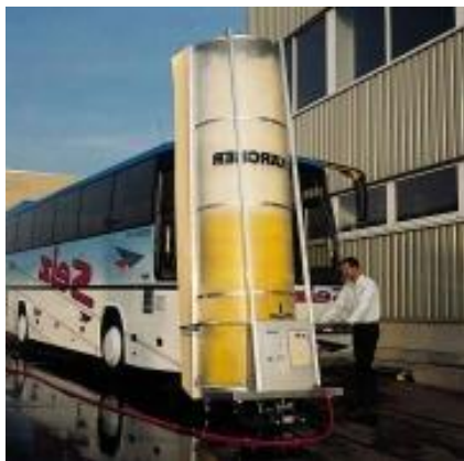
2.9.-rasm. RBS 6000 modelidagi yuvish uskunasi
