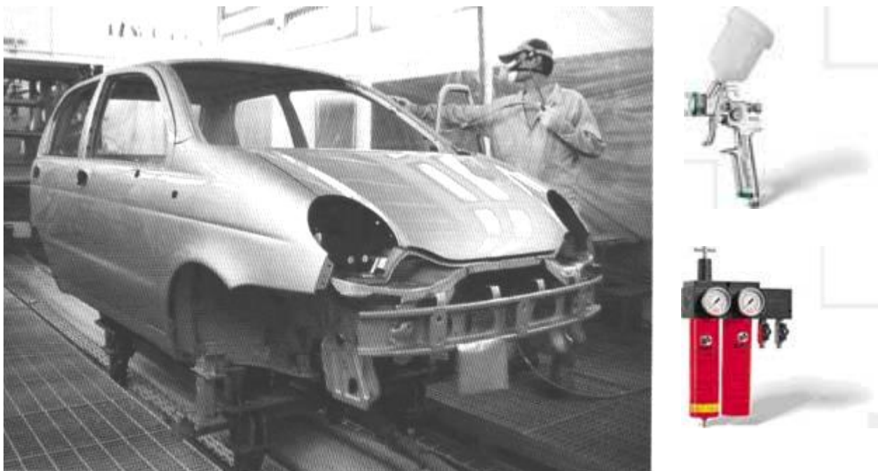
2.24-rasm. Avtomobillarni bo'yash joyi, ustun va pistolet
