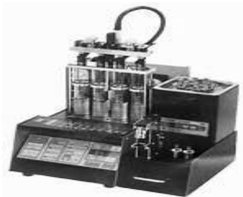
3.6-rasm. Avtomobil dvigatellarining 4 ta injektorini bir yo'la tekshiradigan ultratovushli NA4DFV stendi.
