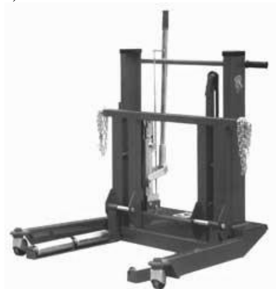
5.35.-rasm. Avtomobillar g'ildiraklarini echib olish, o'rnatish va tashish uchun aravacha. a- umumiy ko'rinishi; b- ish jarayonida.
