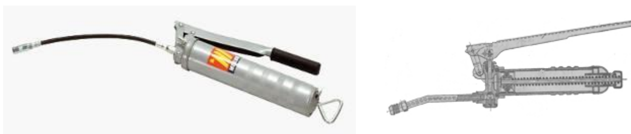
4.44-rasm. 3102- MECLUBE rusumli qo'l shpristi va sxematik ko'rinishi
