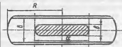
99-rasm. Protektor chizgisini chegaraviy yedirilish yuzasi: R -shina radiusi; B -profil kengligi; b \leq 1/2B ; a \leq 1/6 \cdot 2\pi R .
