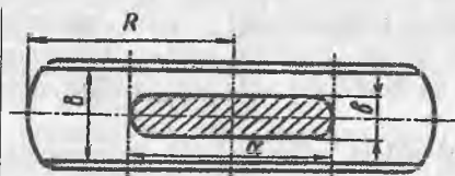
99-rasm. Protektor chizgisini chegaraviy yedirilish yuzasi: R -shina radiusi; B -profil kengligi; b \leq 1/2B ; a \leq 1/6 \cdot 2pR .
