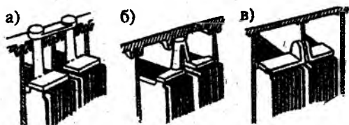
1.38-расм Аккумулятор элементларини ўзаро улаш услублари
