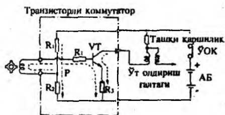
3.37-расм. Тикко, Дамас русумидаги автомобилларнинг ўт олдириш системасини ишлаши
