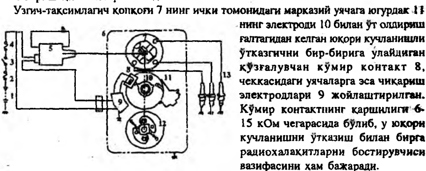
3.36-расм. Тико, Дамас русумли автомобилларнинг ўт олдириш системасининг умумий схемаси:
