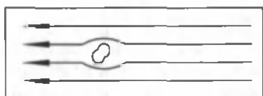
2.1- rasm. Magnit oqimining yoʻnalishini aniqlash sxemasi.
