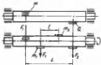
2.6- rasm. Detallarni dinamik muvozanatlash sxemasi.
