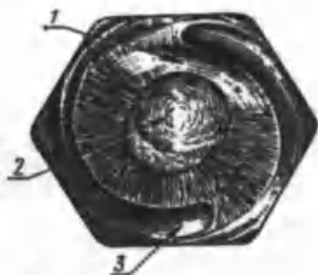
4.7- rasm. Nasoslar turtkichlari plunjeri boltining yeyilishi:
