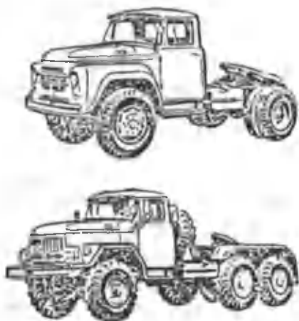
3-расм. Икки ўқли ва уч ўқли эгарли шатакчи автомобиллар: а — ЗИЛ-130В1; б — ЗИЛ-131В1
