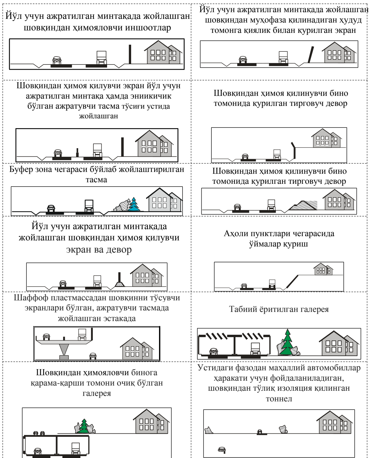
8.6-расм. Энг кўп қўлланиладиган шовқиндан ҳимоя қилувчи иншоотлар схемаси
