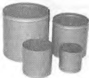
2.8-rasm. Chaqiqto'shning to'kma zichligini aniqlash uchun o'lchov silindrlari
