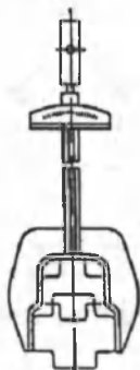
3.40-rasm. Transmissiya agregatlarining texnik holatini aniqlovchi asbob: a—luftomer; b—dinometrik qurilma.
