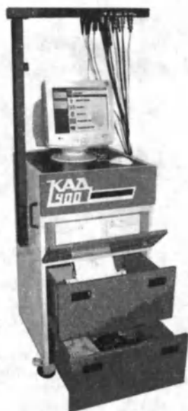
2.33-rasm. KAD-400 rusumli dvigatellarni kompyuterli diagnostikalash kompleksi (KAD-400 ning tarkibiga shaxsiy kompyuter; motor-testor; skaner MT-2E, ossillograf MO-2 va generator GS-1 kiradi. MT-2E kompyuter skaneri «BA3», «ГАЗ» va «УАЗ» avtomobillarining elektron boshqarish bloki tizimini nazorat etish uchun mo'ljallangan).
