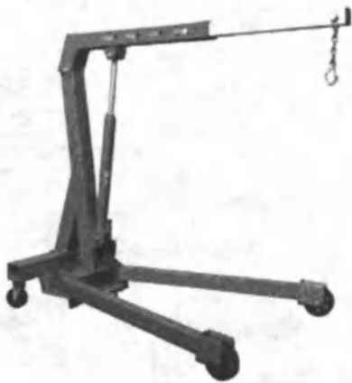
2.11-rasm. Buklanuvchan harakatlanuvchi kran (rusumi 5.1310; yuk ko'tarish qobiliyati 250—500—750—1000 kg; ilib olish balandligi min 10—100—190—280 mm; max 2030—1955—1880—1805 mm; ko'targich uzunligi 1100—1010—920—830 mm; tashqi o'lchamlari 1260x980x1400 mm; og'irligi 75 kg).
