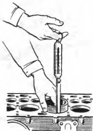
3.7-rasm. Porshen va silindr orasidagi tirqishni tekshirish shakli.
