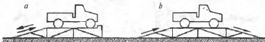
2.4-rasm. Estakadalar: a-boshi berk; b-o'tuvchan.
