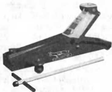
2.9-rasm. Harakatlanuvchi, yuk ko'tarish kuchi 20 tonna bo'lgan gidravlik domkrat (rusumi 5.8204; ko'tarish balandligi 220—680 mm, maydonchasi 179 mm; og'irligi 315 kg).
