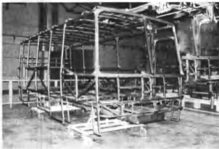
7.7-rasm. Isuzu avtobusi kuzovining ramaga yig'ilgan karkasi.
