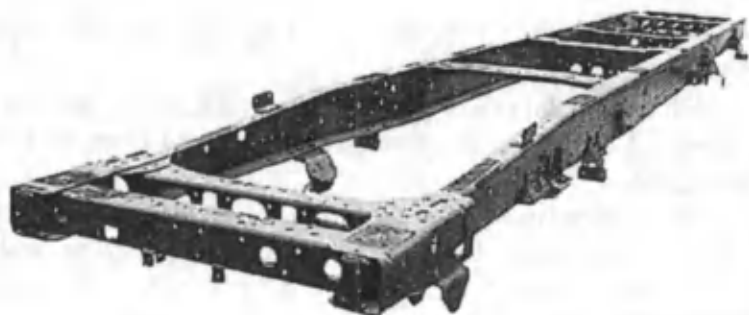
2.5-rasm. Isuzu kichik uzunlikdagi avtobusining ramasi.
