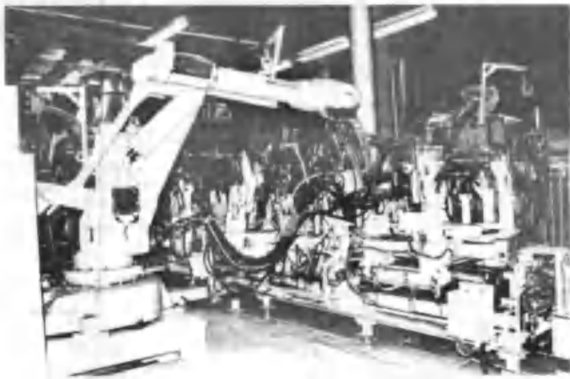
6.7-rasm. Asaka zavodida kuzovni payvandlash avtomatik liniyasidagi robottexnika kompleksi.
