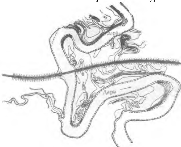
20.4 – расм. Бурилиб оқувчи дарё ўзанининг бурилган жойларининг кўприкка келиш (ўтиш) йўллари кўтармасига яқинлашуви
