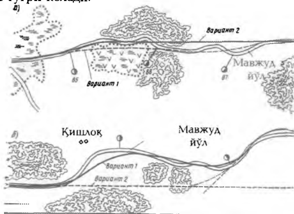
27.6 – расм. Йўлнинг асосланмаган эгри – бугрилигини бартараф этиш мисоллари: а – тўғри участкада; б – эгриларнинг тугашмаларида
