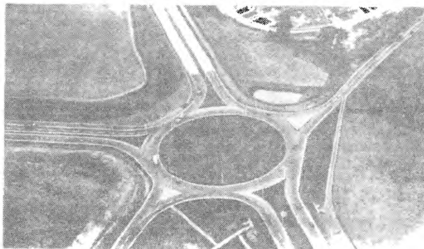
13.6-расм. Бир сатҳдаги ҳалқасимон кесишиш.
