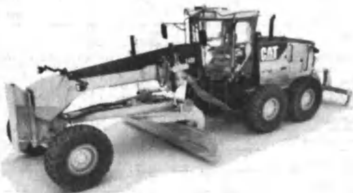
1.4.2-rasm. G'ildirak formulasi 1×2x3 bo'lgan avtogreyder.
