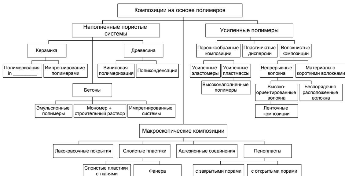
Рис. 18. Схема классификации полимерных композиционных материалов
