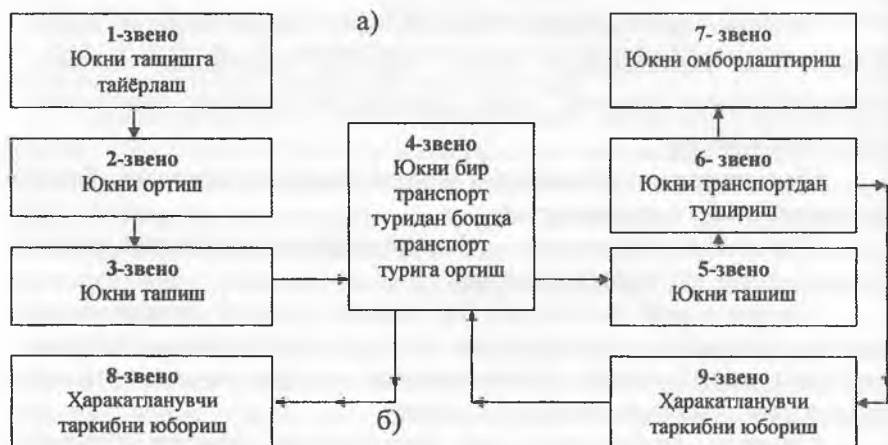
3.2 расм. Юк ташишнинг технологик схемаларига мисоллар: а- битта транспорт турида; б- бир неча транспорт турида.
