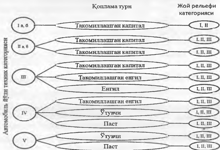
7.7-расм. Автомобиль йўли участкасининг техник таснифланиши.
