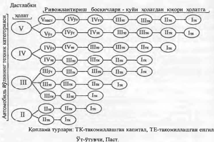
7.8-расм. Автомобиль йўл участкасини босқичма-босқич ривожлантиришнинг схемаси.
