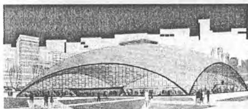
Рис. 15.6.4.5. Примеры покрытий кровли зданий гладкими сферическими оболочками двоякой кривизны: 1 — пример гладкого купола — здание Новосибирского академического театра оперы и балета (арх. А. Гринберг, В. Виркенберг): общий вид; 2 — торговый центр в Челябинске (арх. В. Жадовский, Ф. Селенецкий): а — общий вид, б — план
