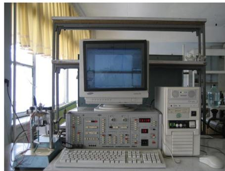
Испытания разработанного аналитического комплекса были проведены нами при исследовании природных и сточных вод, почвы, сельскохозяйственных продуктов питания на содержание в них Pb, Cd, Cu, Hg, Zn. В качестве рабочего электрода был использован ртутно-графитовый электрод.
