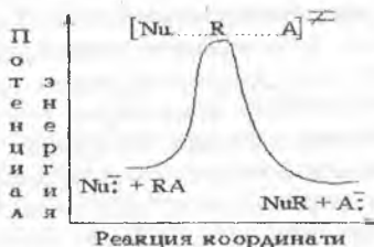
2-Расм. S_N2 механизмининг реакция координаты
