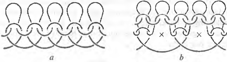
2.2-rasm. Har bir yoki har ikkinchi ignani dastlabki qator ipi bilan o'rab hosil etilgan ishlay boshlash tuzilishi.
