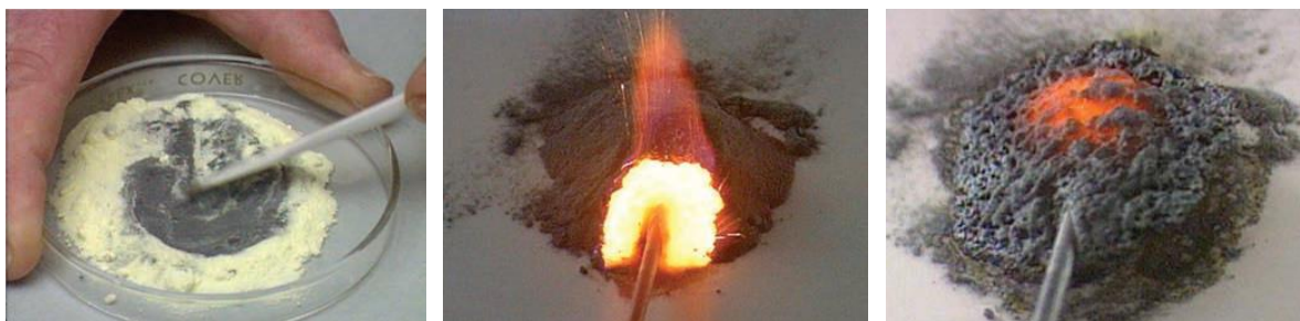
2.6 rasm. Temir va oltingugurt aralashmasi (chapda), ularning o'zaro ta'sirlashuvi (o'rtada) va hosil bo'lgan temir (II)- sulfid (o'ngda) 18 .
