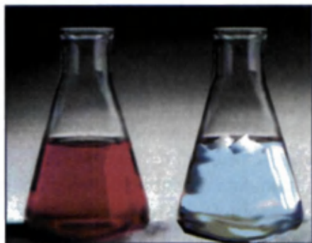
39-rasm. «Quruq muz» va uning fenolftaleini ishqor eritmasi bilan ta'sirlashib, neytrallasishi va indikator rangining yo'qolishi.
