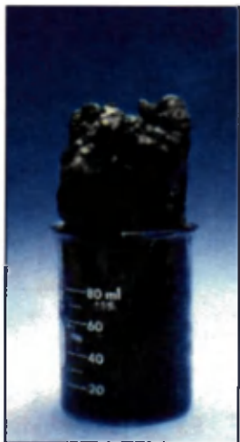
45-rasm. Sulfat kislota-ning yog'ochga ta'siri.
