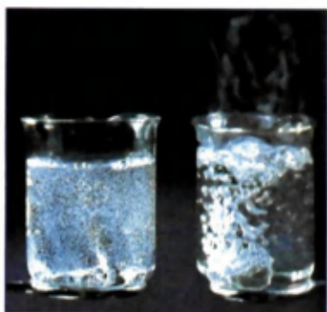
34-rasm. Ruxning turli konsentratsiyali sulfat kislotasi eritmasi bilan ta'sirlashuvi.
