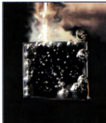
43-rasm. Ruxning sulfat kislotada erishi va vodorod ajralib chiqishi.
