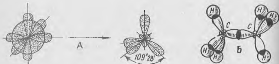
25-расм. А. s — ва p — орбиталлардан углерод гибрирд орбиталларининг ҳосил бўлиши. Б. Этан молекуласидаги C - C ва C - H боғларининг ҳосил бўлиши.
