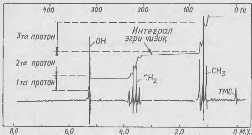
7-расм. Этанолнинг ПМР — спектри. Кимёвий силжишлар ТМС га нисбатан \delta шкалада берилган
