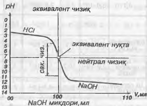
36-расм. HCl нинг 0,1 н эритмасини NaOH нинг 0,1 н эритмаси билан титрлаш эгри чизиғи
