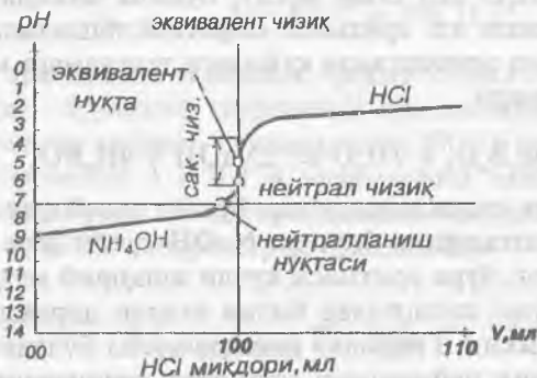
38-расм. \text{NH}_4\text{OH} нинг 0,1 н эритмасини HCl нинг 0,1 н эритмаси билан титрлаш эгри чизиги
