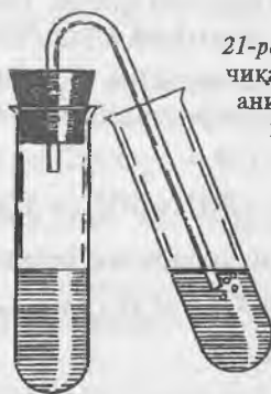
20-расм. Реакцияда ҳосил бўладиган газларни аниқлаш асбоби.
