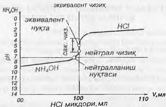
2.17-расм. \text{NH}_4\text{OH} нинг 0,1 н эритмасини \text{HCl} нинг 0,1 н эритмаси билан титрлаш эгри чизиғи.
